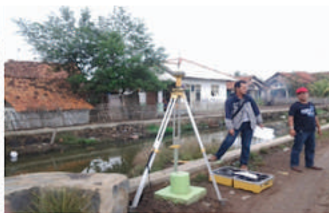
Gambar 26. Dokumentasi operasi pemantauan penurunan tanah menggunakan GNSS di pantai Utara Jawa serta Perangkat pemantauan penurunan tanah di Shanghai
