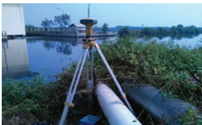
Gambar 26. Dokumentasi operasi pemantauan penurunan tanah menggunakan GNSS di pantai Utara Jawa serta Perangkat pemantauan penurunan tanah di Shanghai
