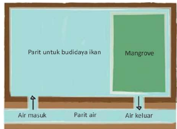
Gambar 17b: Modifikasi dari tambak biasa dengan parit tanpa tanggul tengah, yang disebut Model Komplangan (Sofiawan, 2000). Diakui secara resmi oleh Kementerian Kehutanan (2004) sebagai opsi kedua dari empat opsi silvofishery (ilustrasi diadaptasi dari: Audrie Siahainenia).
