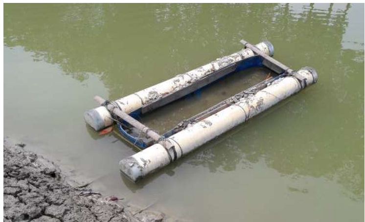
Gambar 11: Sekop dan rakit yang digunakan untuk mengeruk tambak dan mengumpulkan sedimen untuk membangun tanggul (© Roel Bosma)
