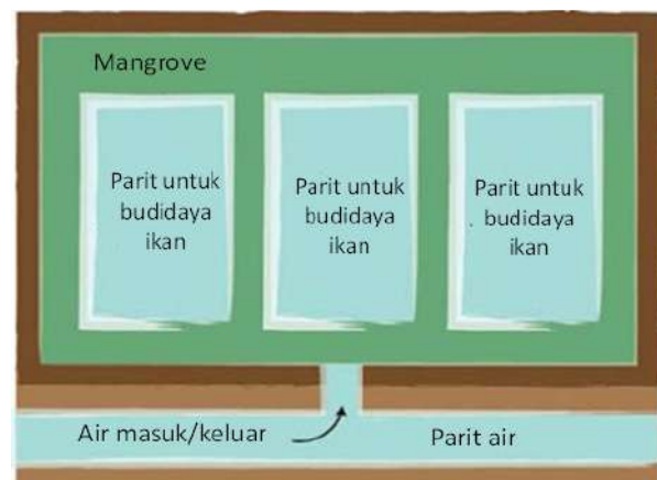
Gambar 17d: Model Kao-Kao dengan tiga parit terpisah dengan sistem satu pintu air. Air dapat mengalir dari parit ke parit, tergantung pada pasang surut air laut (Sofiawan, 2000). Perhatikan bahwa area yang berwarna lebih terang adalah saluran, bukan tanggul (ilustrasi diadaptasi dari: Audrie Siahainenia).
