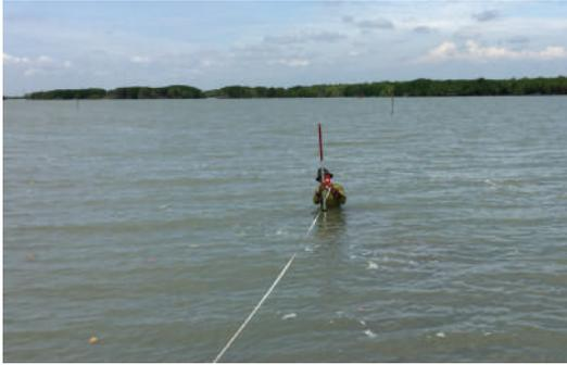
Gambar 16. Pengukuran ketinggian lapisan tanah yang keras © Bagus Maulana
