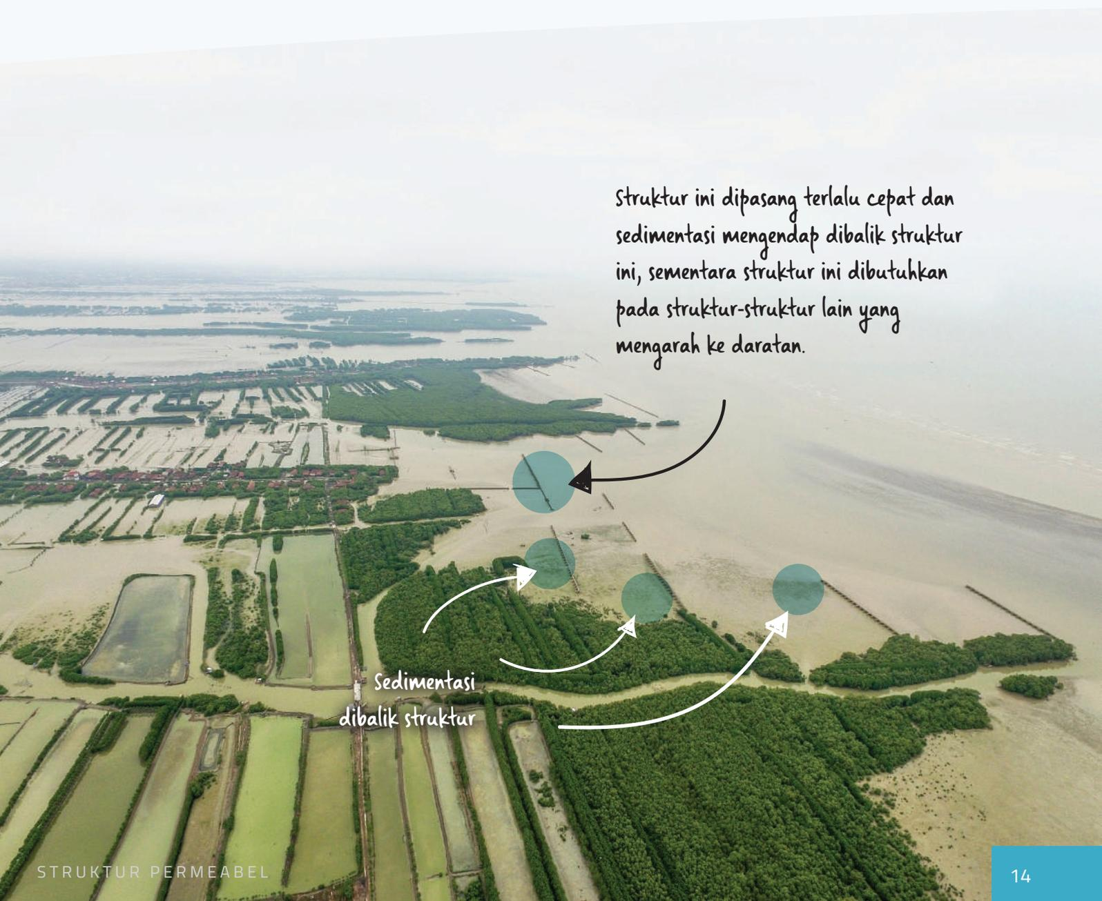
Struktur ini dipasang terlalu cepat dan sedimentasi mengendap dibalik struktur ini, sementara struktur ini dibutuhkan pada struktur-struktur lain yang mengarah ke daratan.
