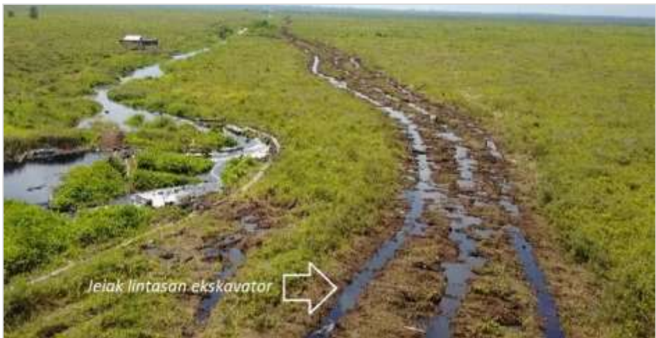
Gambar 73. Jejak lintasan ekskavator di atas lahan gambut di dalam Tahura OKH menyebabkan pepadatan/ compaction (Foto Drone oleh I.Reza Lubis, 1 Feb 2018).
