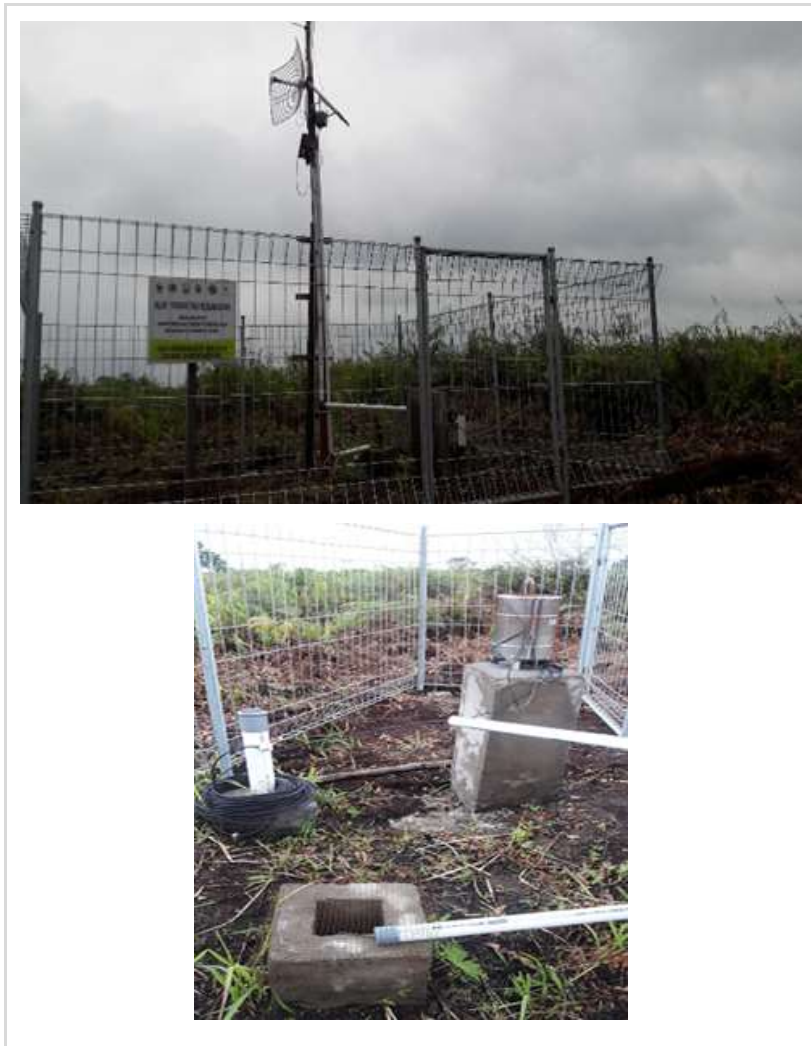
Gambar 62. Pemancar EWS (kiri) dan dua sumur pantau (kedalaman air tanah dan kelembaban tanah), kanan. (Foto: Nyoman Suryadiputra, Februari 2018).
