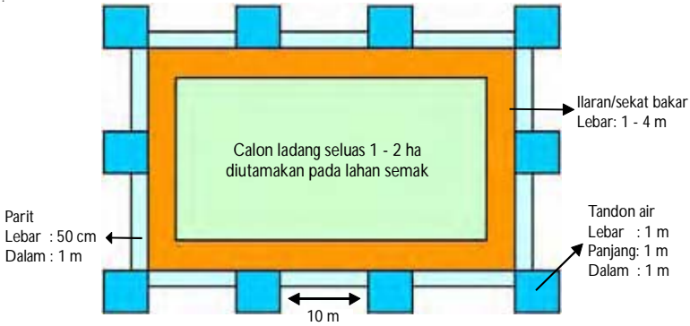
Teknik penyiapan lahan di lahan gambut (Syaufina, 2003)
